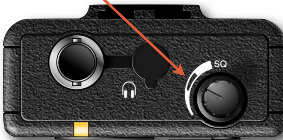
Figure 3 - Réglage du réducteur de bruit de fond (squelch)
